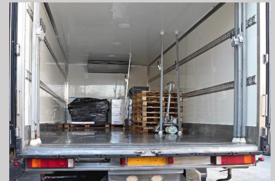
Sichern der Ware mit dem Spannbalken
